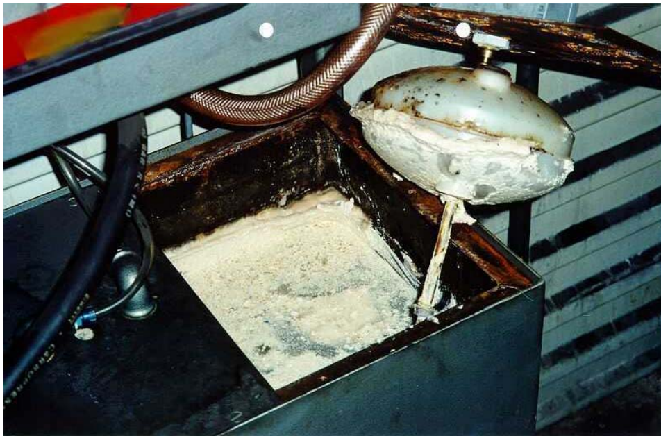
Bild 2: Biologische Arbeitsstoffe treten oft im Zusammenhang mit wässrigen Systemen auf, wie hier in Ablagerungen eines Kühlschmierstoffvorhaltebeckens
