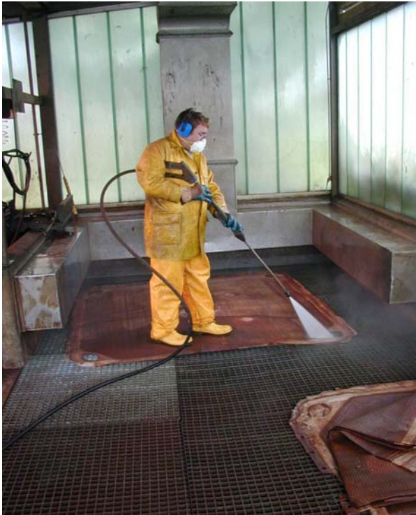
Bild 3: Die Exposition von Beschäftigten gegenüber biologischen Arbeitsstoffen erfolgt oft in Form von Aerosolen, was z.B. durch das Tragen persönlicher Schutzausrüstungen vermieden werden kann. Hier die HD-Reinigung einer Filterkammer-Presse einer Kläranlage.
